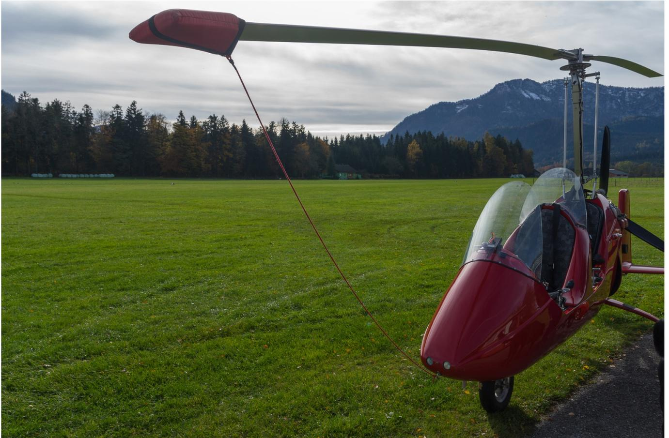
Der 100PS Rotax sorgt für den nötigen Schub nach vorne. Der Rotor wird durch den Fahrtwind angetrieben und ist für den Auftrieb verantwortlich.
