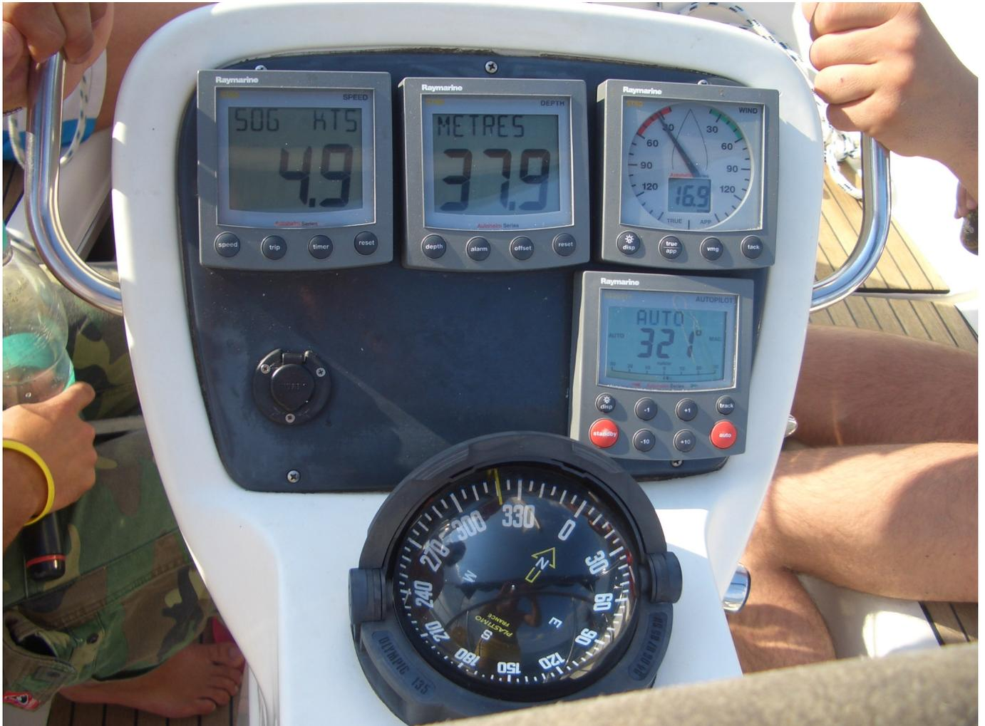
Hi-Tech Equipment, von links nach rechts, Geschwindigkeitsmesser, Tiefenmesser und Windrichtung.
